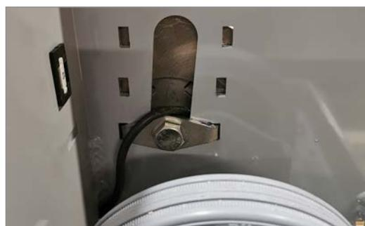
3. Installez l'axe sur les modules à l'aide de la rondelle pliée.
