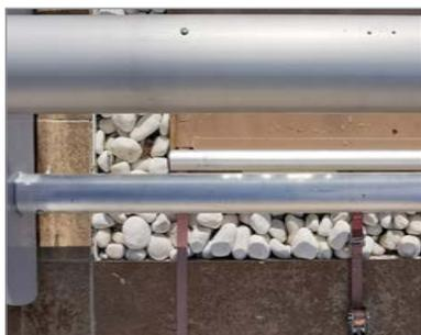
1. Positionnez l'axe de transmission au niveau de la première barre de la couverture
