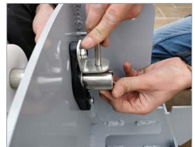
4. Installez l'axe d'enroulement sur le module opposé et réitérez le verrouillage.
