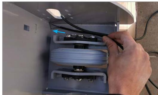
2. Faites passer le câble du panneau solaire dans le passage de câble du module moteur.
