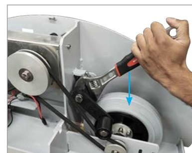
3. À l'aide d'une clé à molette ou d'une pince multiprise, exercez une force sur le tendeur afin de tendre la courroie.
