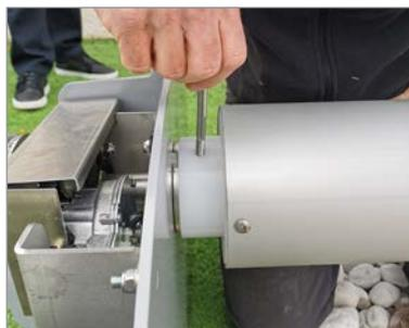
3. Verrouillez-le à l'aide de la vis M8x120, rondelle et écrou frein prévus à cet effet.
