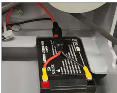
4. Raccordez la batterie au boîtier électronique.
