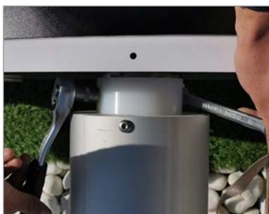
1. Pour débrayer l'enrouleur motorisé, dévissez et retirez la vis M8x120
